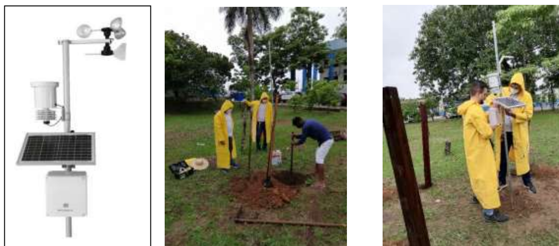
Figura 10 – Modelo das Estações Meteorológicas do projeto e o processo de instalação Fonte: Organizado pelos autores, 2022.
