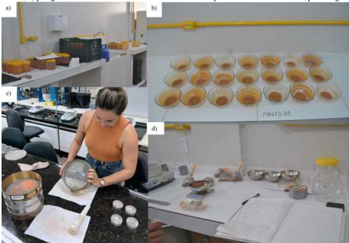
Figura 8 – Procedimentos laboratoriais da segunda etapa metodológica: a) potes com água e sedimentos coletados durante o experimento SCPA; b) tigelas apenas com sedimento para quantificação após realizado o método de evaporação; c) procedimento de peneiramento dos sedimentos desprendidos durante o experimento SCPA; d) pesagem das amostras coletadas em 0-5 e 5-10 cm de profundidade com umidade, pré-secagem
