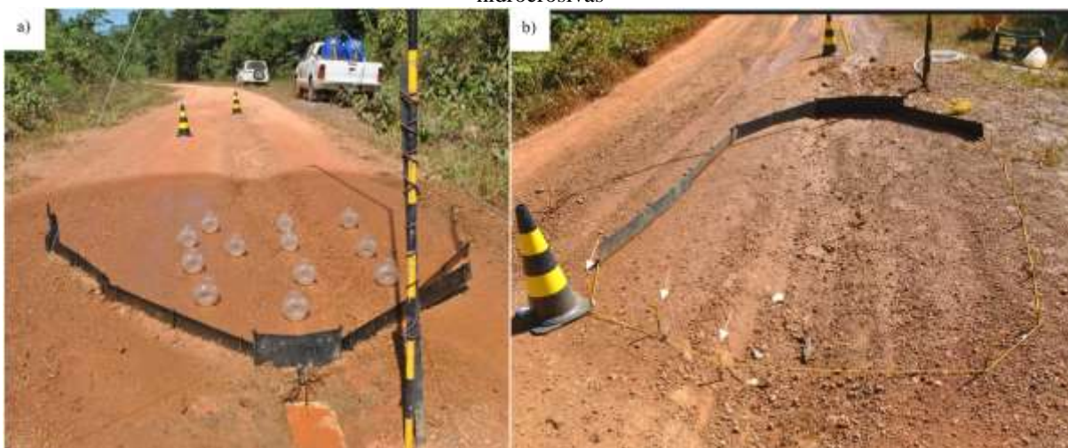
Figura 7 – a) Disposição de pluviômetros manuais para mensuração da intensidade de precipitação durante o experimento SCPA; b) as setas brancas apontam para os parafusos de ferro utilizados para delimitar as parcelas hidroerosivas
